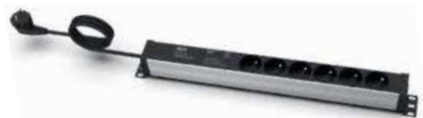
Listwa zasilająca EmiterNet 19" 6-gn.z bolcem, zabezpieczenie przeciwprzepięciowe + filtr przeciwzakłóceńowy, kabel 3mb wtyk uni-schuko KOD: EM/LZ19.06F.3S.VI
